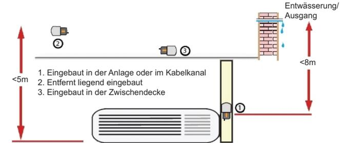
Schließen Sie eine flexible PVC Kondensatabflussleitung an die Pumpenabgangsstelle an und führen Sie diese in eine entsprechende Abflussleitung. Stellen Sie sicher, dass die flexible Kondensatabflussleitung an keiner Stelle scharf geknickt oder verdreht wird. Vergewissern Sie sich weiterhin, dass die Kondensatabflussleitung keine beweglichen oder scharfkantigen Gegenstände berührt. Diese könnten zu einer Beschädigung des Schlauches führen.
