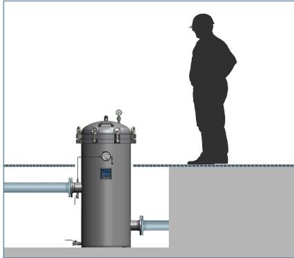
Schacht- / Überlaufbeckeneinbau
