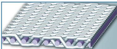
Die Köpertresse-Webart ergibt für Monofilamente die kleinsten Filterporen bei glatter Gewebeoberfläche. Der große Materialquerschnitt garantiert eine hohe Festigkeit. Feinheitsbereich 1-20 µm
