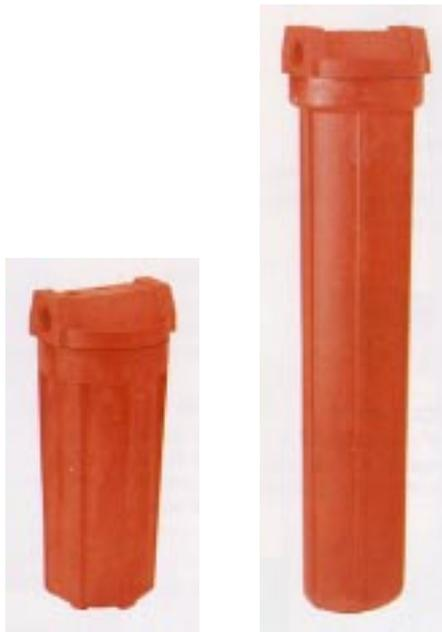
Die Filtergehäuse vom Typ FFU R34 und FFU R44 bestehen aus glasfaserverstärktem Nylon, welches rot eingefärbt ist und nehmen eine einzelne Filterpatrone mit einer Länge von 248 bzw. 508 mm auf. Der Werkstoff ist äußerst temperaturbeständig und eignet sich daher besonders zur Filtration von heißem Wasser, Salzlösungen, Alkoholen, sowie organischen Lösungen.
