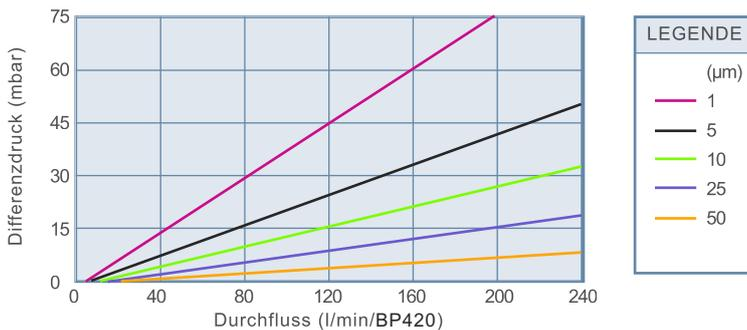
Die Ermittlung der Werte erfolgte mit Wasser / 20°C
