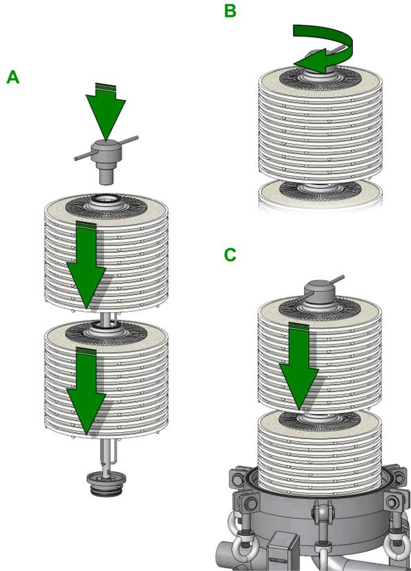
Zur leichteren Montage O-Ringe mit Wasser oder Filtermedium anfeuchten!
