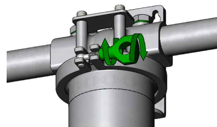
Flügelmutter anziehen. Tighten wing nut.
